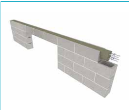
VOLTINO / CORREA SEMPLICE H20 CM CON ELEMENTO SPECIALE CANALETTA E GABBIA D'ARMATURA DEDICATA
