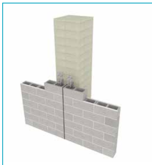
VINCOLO MURATURA CON ZANCHE FILO ESTERNO PILASTRO
